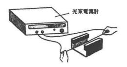
將長導線連接電流計/和顯示接取儀器。 使導線在磁鐵間的磁場內運動。 <u>相對運動:</u>使導線暨直向下運動然後向上運動切割磁場。
